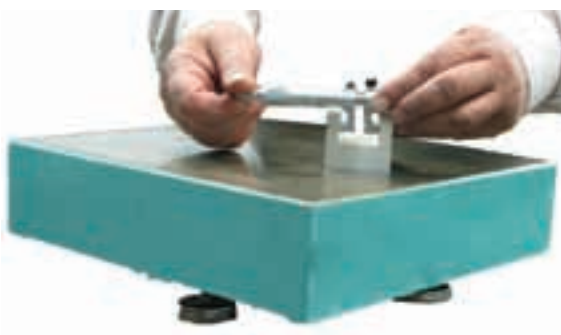
شکل ۶-۵- اندازه‌گیری پهنای شیار قطعه‌ی ناودانی
