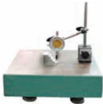
شکل ۱-۶- اندازه گیری قطعه‌ی یله‌ای
