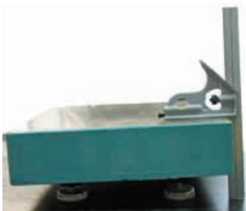
شکل ۹-۷-اندازه‌گیری ارتفاع صفحه‌صافی
