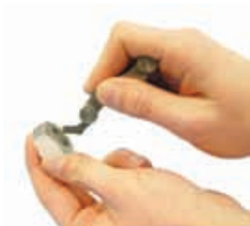
شکل ۱۳-۸- تعیین تعداد دندانه در یک اینچ مهره
