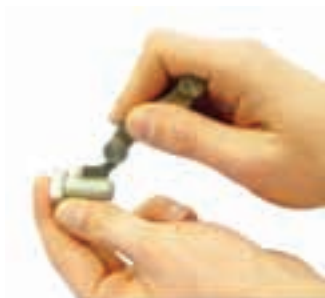
شکل ۱۱-۸- تعیین تعداد دندان‌ها در یک اینچ پیچ اینچی
