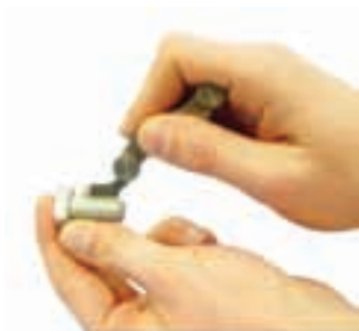
شکل ۱۰-۸- تعیین گام پیچ
