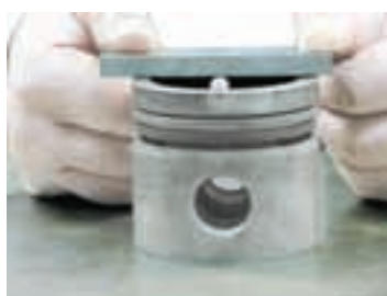
شکل ۶-۸- اندازه‌گیری پیستون با گلوله‌ی اندازه‌گیری
