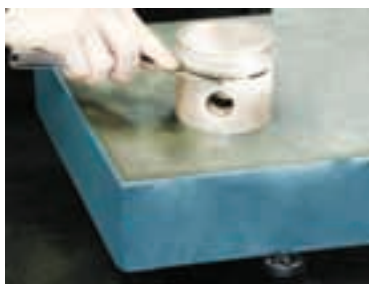
شکل ۵-۸- اندازه‌گیری پیستون توسط فیلر
